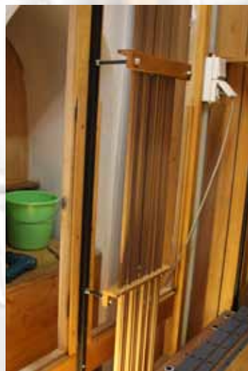
Filigrane Hebelwerke zum Ansteuern der einzelnen Pfeifen
